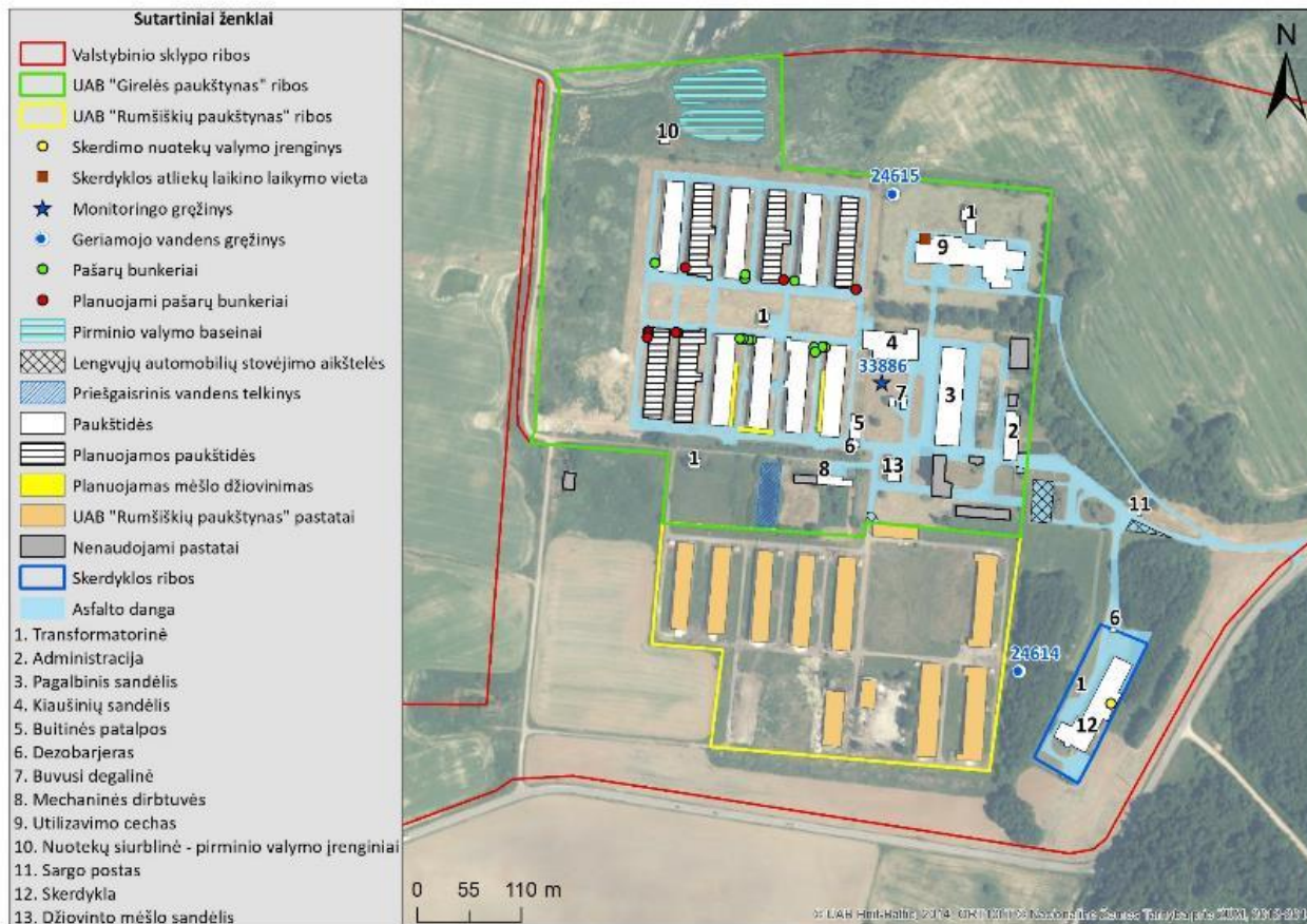
10 pav. UAB „Girelės paukštynas“ gamybinės teritorijos bei esamų ir planuojamų technologinių statinių ir įrenginių išdėstymo planas
